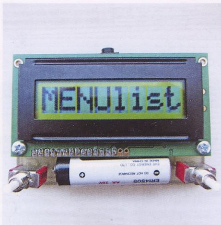
Pogled na elektroniko podporne naprave pred pritrditvijo na čelno ploščo
