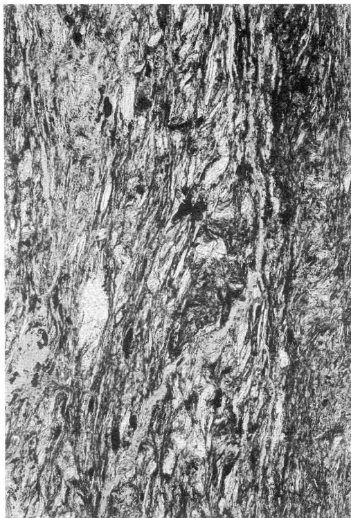
Sl. 3. V smeri s_1 prednostno orientirani filosilikati. Večji detritični listki muskovita so v osrednjem delu slike le delno mehansko reorientirani. Mikrorazpoka sledi smeri s_1 in rotirani smeri s_0 v spodnji polovici slike. Viadukt Log, || N, 107 \times .
