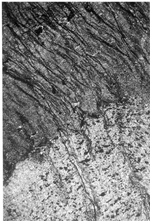
Sl. 2. Sekundarna skrilavost s_1 s koncentracijami neprosojnih mineralov poteka prečno na plastovitost s_0 . Glinasta lamina se je močnejše deformirala kot meljasta. Nastaja plisiran klivaž. Viadukt Vranke, VR-761, +N, 8 \times .
