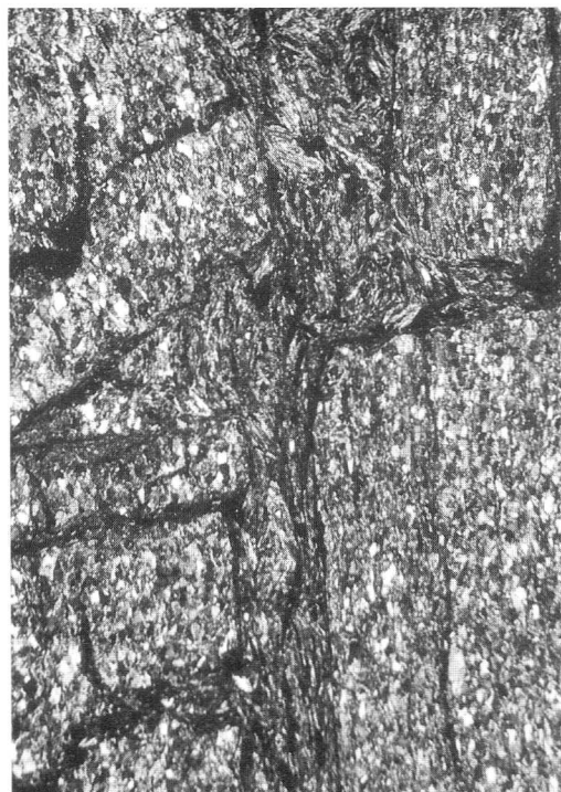
Sl. 7. Šibko metamorfoziran pešeni meljevec razpokan zaradi zdrsa vzdolž mikrolamine glinastega skrilavca. Viadukt Javorje, +N, 15 ×.
