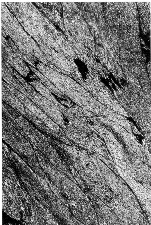
Sl. 5. Mikroskopski izgled lečasto-luskasto razpokanega glinastega skrilavca vzdolž značilne prednostne orientacije filossilikatov (prevladuje sericit). Viadukt Log, +N, 20 \times .
