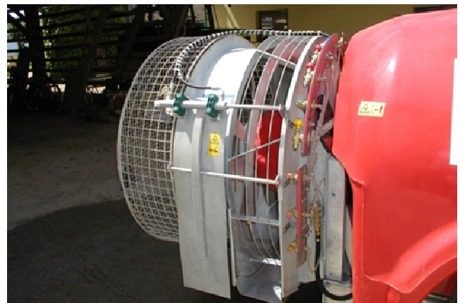
Slika 2: Sodoben hmeljarski pršilnik z nameščeno zračno zaporo ter vgrajenimi šobami za zmanjševanje zanašanja.
