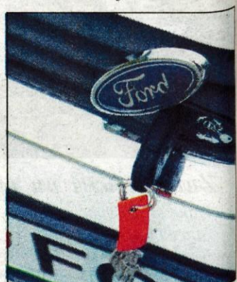
Zanimivo, vendar ne preveč prikladno: odpiranje motornega pokrova s ključem.
