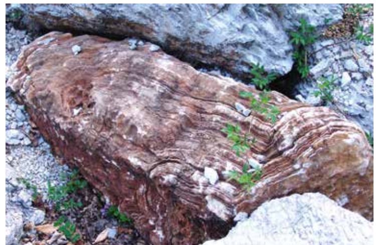
Siga iz razširjenih tektonskih razpok oz. votlin v razkosanem in pretrtem glavnem dolomitu kamnoloma Draga
