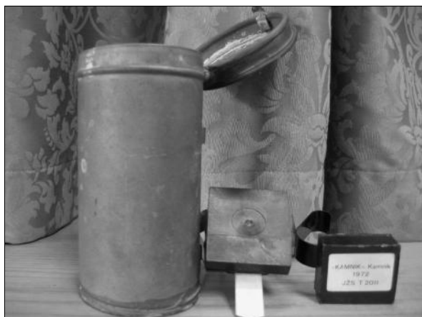
Slika 5: Razpočnika s škatlo, v kateri so se hranili. Na železnici se več ne uporabljajo. Razpočniki so se v izjemnih primerih, ko je bilo treba ustaviti vlak, postavili na tračnico. Zaradi vsebine z razstrelivom je prišlo do poka, kar je za strojevodjo pomenilo, da se mora ustaviti.
