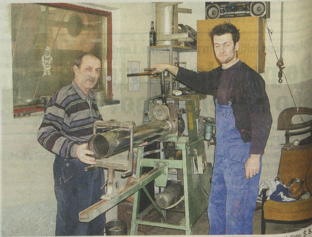
Makovčeva oče Anton in sin Roman pri doma narejenem stroju za valjanje navojev za nerjavne dimniške cevi. Foto: S. S.
