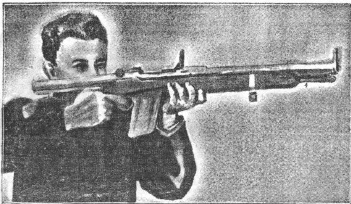
Nova brzostrelna puška. Strojni inženjer Miodrag Stojanović v Skoplju je po dveletnem napornem delu iznašel nov tip strojne puške ali kakor se vojaško imenuje: »puško-mitraljez«. Kaliber znaša 8 mm, dolžina cevi 480 mm, dolžina cele puške 1020 mm, tehta 5 kg 750 g. Napolnjuje se lahko po 25, do 100 patronov. V min. izstrelí do 300 krogel.
