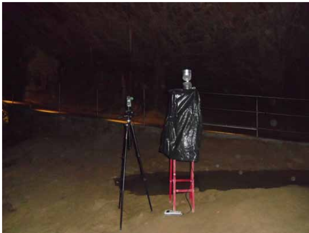
Slika 8: Vzorčevanje zraka v Tibi jami (Šotor) za mikrobiološke analize ob hkratnem merjenju atmosferskih parametrov – temperature, relativne vlage in koncentracije ogljikovega dioksida. Foto: Janez Mulec, 2014.
