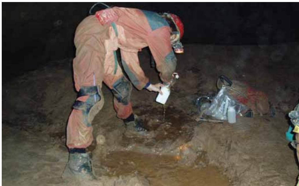
Slika 6a: Precejanje vode iz luže na dnu jamskega rova ob uporabi filtrirne plastenke. Foto: Tanja Pipan.
