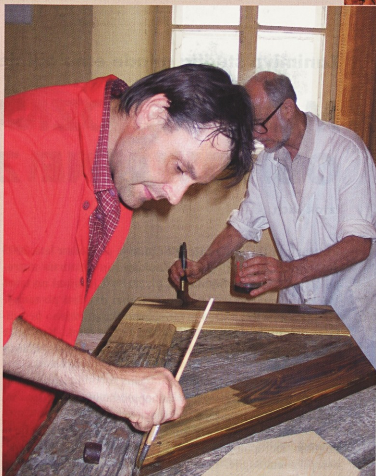
Delavnica mizar, restavratorski sodelavec: restavriranje vratnih kril
