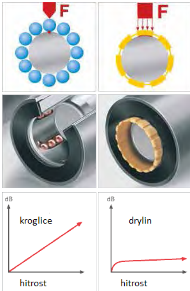
Slika 1: Kroglična vodila – a in drsna vodila – b
