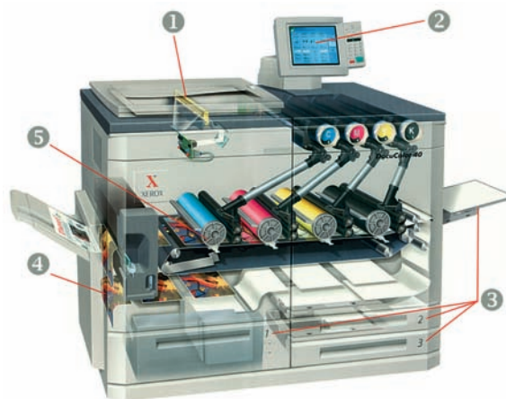
Slika 25. Štirbarvni elektrofotografski stroj s tiskovnim trakom za prenašanje pol. Ker se barvni izvlečki natisujejo drug za drugim, je to multiprehodni sistem (multipass system). Uporaben je tudi kot barvni fotokopirni stroj in lahko tiska obojestransko. Glede na zmogljivost sodi med pisarniško-industrijske stroje. Na sliki pomenijo: 1 – analogni snemalnik za fotokopiranje, 2 – zaslon za upravljanje stroja, 3 – vlagalni predali za različne formate papirja, 4 – obračalnik za obojestranski tisk, 5 – upodobitveni valji v tiskovnih členih; toner prihaja po cevovodih iz povsem ločenih barvnikov (kartuš).
