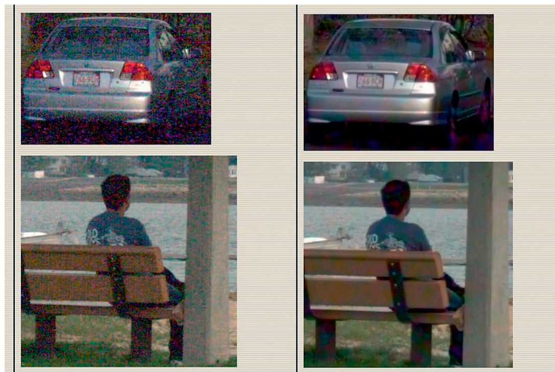
Slika 4. Uspešnost nove zasnove snemalnega vezja je Gang Luo dokazoval s simulacijo na podlagi podosvetljenih surovih posnetkov (slikovni format RAW), ki jih je izdelal z digitalnim fotoaparatom Canon 30D. Ta ima na snemalnem vezju formata APS-C (22,5 × 15,0 mm) po Bayerjevem načelu razporejenih 8,5 milijona fotoelementov. Pri tej razporeditvi se pojavi močan slikovni šum (levo), pri Luovi izgine, izboljša pa se tudi upodabljanje podrobnosti (desno).
