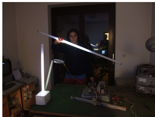
Slika 8: Praktičen primer prikaza bližnjega polja z visokonapetostnim virom 15 kV in nizkotlačno fluorescentno žarnico: kapacitivni sklop [2]
