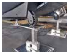
Slika 4: Senzorji sil v horizontalni smeri x in vertikalni smeri y – shematski prikaz levo in desno fotografiji senzorjev v smeri x (A) ter smeri y (B).
