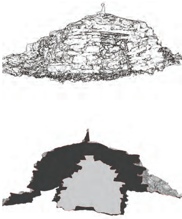
Slika 6. Avtomatski izris in presek 3D modela hiške.
