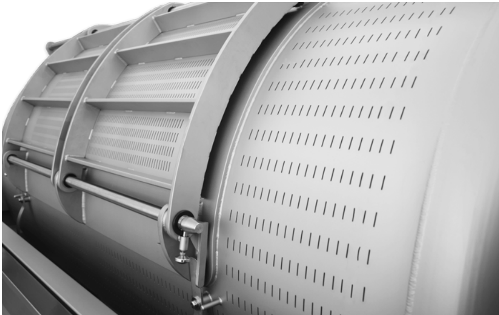
Slika 9. Boben stiskalnice (vir: Podjetje Šraml).
