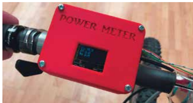
Slika 11: Prikazovalnik sile, kadenca in povprečne moči na krmilu.
