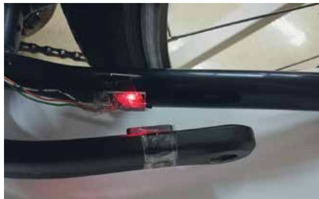
Slika 10: Merjenje frekvence pedaliranja. Pritrditev trajnega magneta na gonilko in Hallovega senzorja na okvir.
