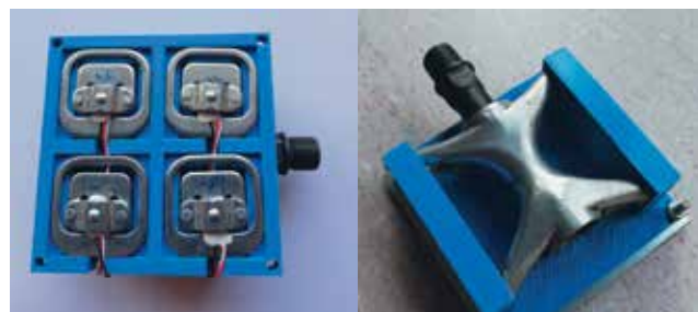
Slika 7: Spodnji del platforme brez merilnikov (desno) in zgornji del platforme s štirimi dualnimi uporovnimi lističi (strain gauge) vezanimi v mostič (levo).
