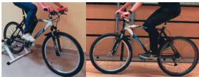
Slika 13: Testiranje delovanja merilnika moči na trenažerju (levo) in testna vožnja v telovadnici (desno).
