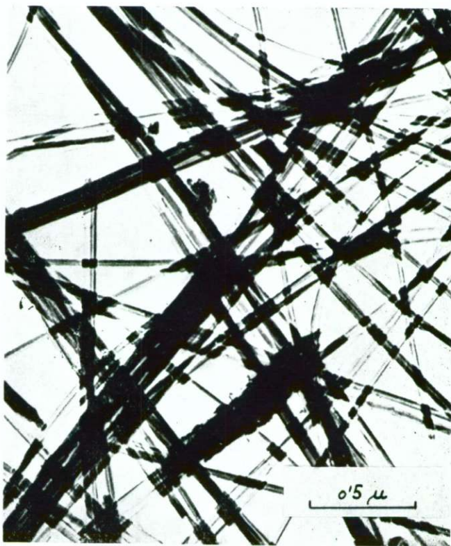
2. sl. Elektronski mikroposnetek rujištanskega azbesta pri 40.000-kratni povečavi Fig. 2. Electron microscope picture of the Rujište-asbestos, 40.000 diams.
