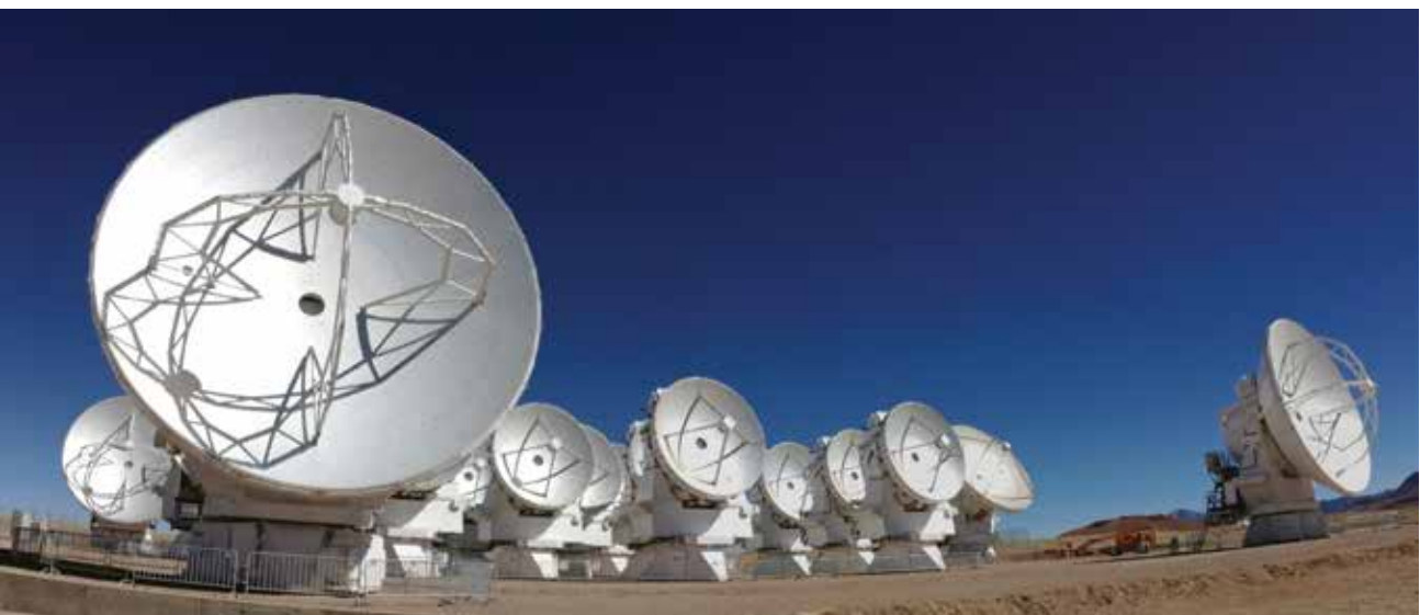
Antene ACA (Atacama Compact Array, Kompaktna mreža Atacama) imajo premer krožnika sedem metrov in so postavljene tesno skupaj. Z njimi lahko astronomi opazujejo radijske valove z valovnimi dolžinami od tri desetine do tri milimetre. Kompaktna mreža Atacama se nahaja na nadmorski višini pet tisoč metrov in je sestavljena iz dvanajstih krožnikov, ki lahko delujejo samostojno ali skupaj kot interferometer. Foto: ALMA(ESO/NAOJ/NRAO).
