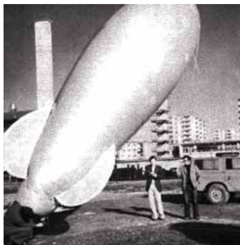
Slika 8. Balon »cigara«, ki je privezan z vrvico prav tako nesel malo več merilne opreme v višino do 800 m. (Foto: arhiv ARSO)
