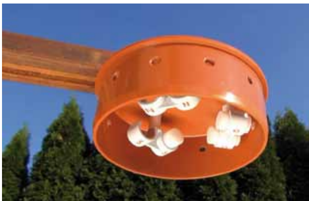
Slika 3. Pasivni vzorčevalniki za spremljanje vsebnosti dušikovih in žveplovih spojin ter ozona v zraku, z ohišjem, razvitim in izdelanim na Gozdarskem inštitutu Slovenije v letu 2013.
