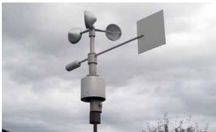
Slika 5. Vetromer, razvit na osnovi prototipa na sliki 4, ki ga je najprej izdeloval Institut Jožef Stefan, kasneje pa AMES. Od začetka sedemdesetih let preteklega stoletja ga je HMZ uporabljal za meritve vetra v mreži meteoroloških postaj, na letališčih, pa tudi za meritve v zvezi z onesnaženjem zraka. (Foto; arhiv ARSO)
