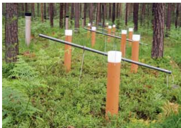
Slika 5. Vzorčevalniki za usedline na ploskvi Brdo v okviru intenzivnega spremljanja stanja gozdnih ekosistemov a) na prostem b) v sestoju.
