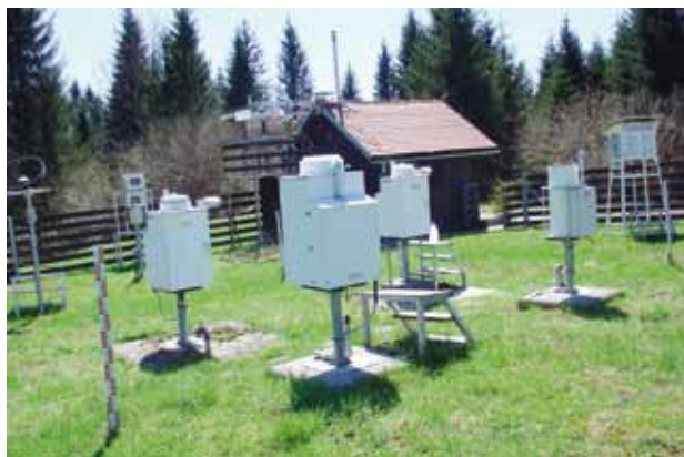
Slika 36. EMEP merilna postaja v Iskrbi za spremljanje transporta onesnaženega zraka na velike razdalje. (Foto: arhiv ARSO)
