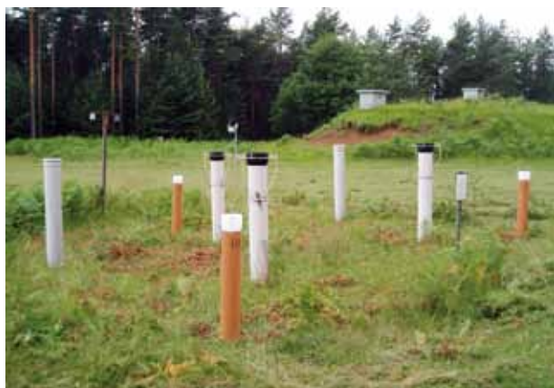
Slika 5. Vzorčevalniki za usedline na ploskvi Brdo v okviru intenzivnega spremljanja stanja gozdnih ekosistemov a) na prostem b) v sestoju.
