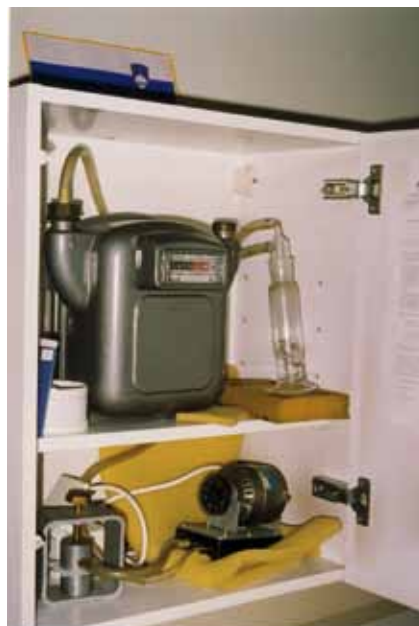
Slika 2. Posodobljeni napravi za merjenje povprečnih dnevnih vsebnosti dima in \text{SO}_2 , s pomočjo katerih so na več kot petdesetih lokacijah v Sloveniji merili vse do današnjih dni. Največ dima so izmerili v Zagorju, \text{SO}_2 pa v Trbovljah (Foto: arhiv ARSO)
