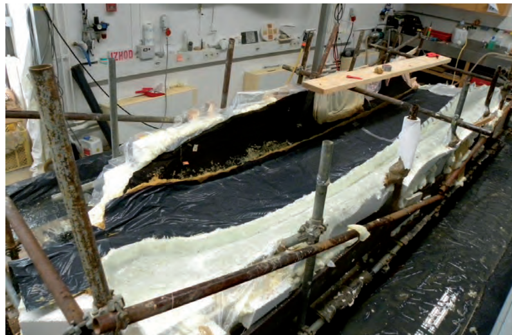
Izdelava epoksi kapsul za zaščito deblaka med konservatorskim posegom na Restavratorskem centru ZVKDS. Foto: Katja Kavkile
