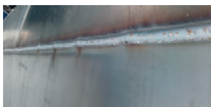
» Slika 3. Varjenje s pomočjo sistema MOTOSense
