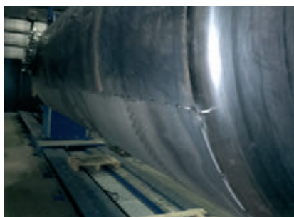
» Slika 2. Kovinska cisterna s točkovnimi zvari
