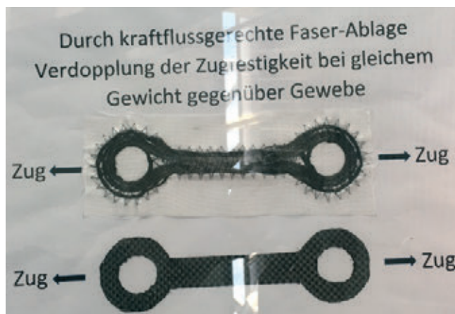
» Slika 4: Primer dela iz šivanega kompozita (zgoraj) in klasičnega laminiranega kompozita za prenos nateznih sil preko lukenj. Šivani kompozit ima višjo trdnost zaradi neprekinjenih vlaken okoli lukenj.
