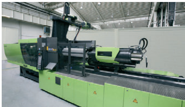
» Slika 2: Brizgalni stroj ENGEL tipa Victory 180, na katerem je integriran MOLDEYE INSPECTOR
