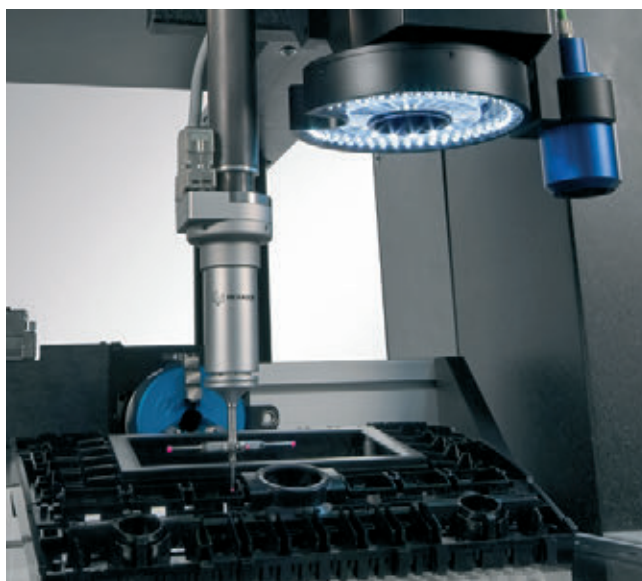
» Multisenzorska platforma Optiv vključuje (od leve proti desni) dotično sondo, kamero in svetlobni senzor bele svetlobe.
