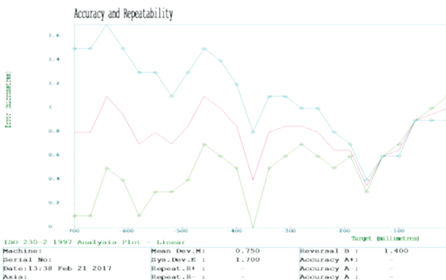
» Slika 13: Rezultat meritve pozicijske točnosti Y osi po vnesenih kompenzacijah
