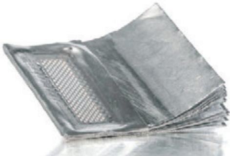
» S torzijskim postopkom Telsonic se zelo tanke folije varijo v pakete brez poškodb na občutljivi zgornji foliji.
