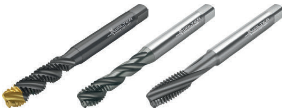
» Svedri za rezanje navojev TC120, TC121 in TC122 Walterjeve linije supreme omogočajo rezanje slepih navojev v jeklene materiale, ki izkazujejo različne natezne trdnosti; od 300 do 1400 N/mm 2 . Slika: Walter AG
