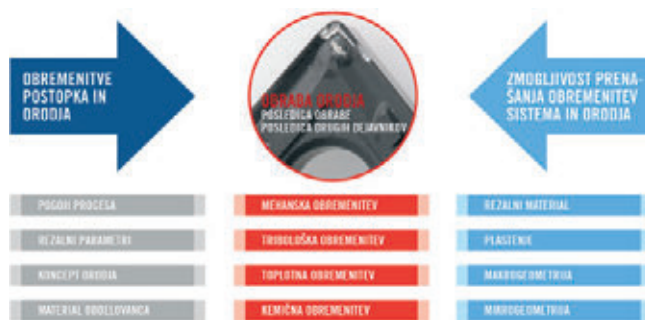
» Slika 2 – Celoten model obdelovalnosti, razvit v programu STEP.
