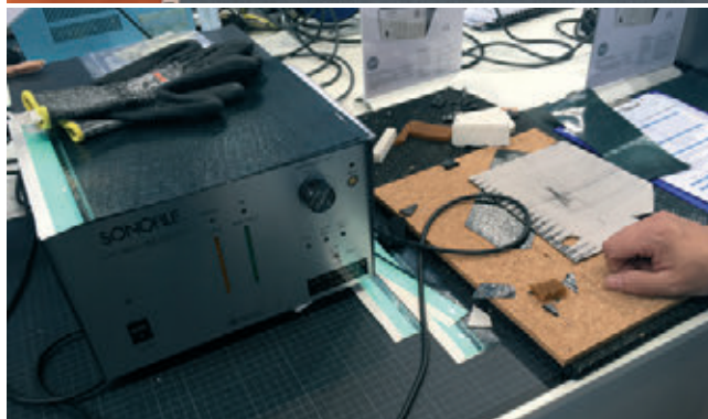
» Slika 2: Ultrazvočni ročni rezalnik preprega do debeline 15 mm za več slojev hkrati (DJK Europe GmbH)
