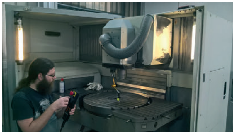
» Slika 2: Mehanske meritve točnosti stroja
