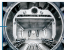
238 Popolnoma avtomatsko pranje elektronskih komponent z modificiranim alkoholom
