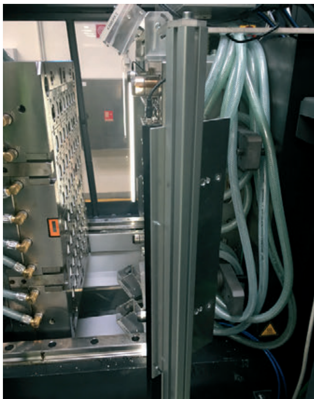
» Slika 1a: Integriran MOLDEYE INSPECTOR na orodje stroja za brizganje plastike
