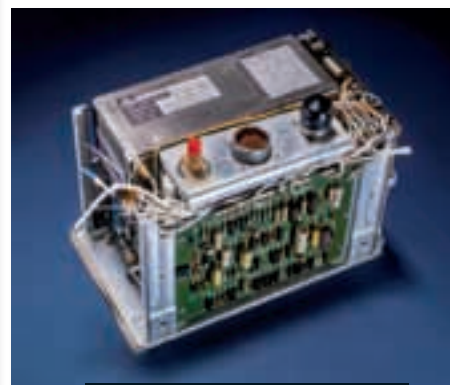
Rubidijeva atomska ura za prvo generacijo satelitov GPS.
