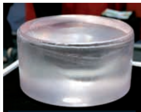
Ingot monokristalnega safirja pred rezanjem. Vir: GT Advanced Technologies
