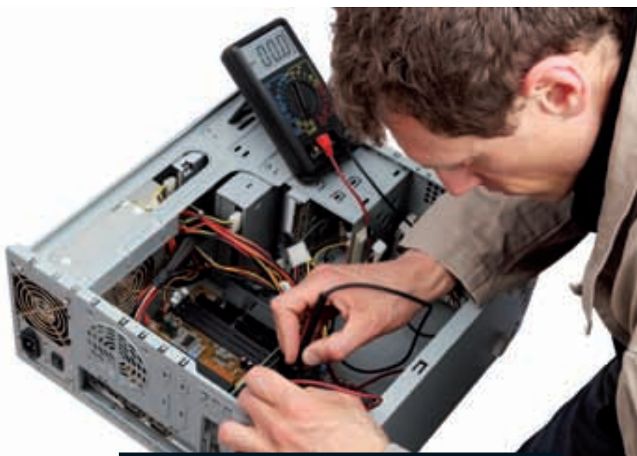
Uporaba multimetra kot pripomočka za popravilo računalnika
