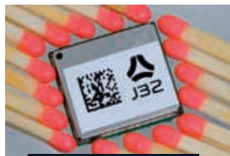
Tipičen modul GPS meri vsega nekaj kvadratnih centimetrov. Na posnetku: Navman J32.
