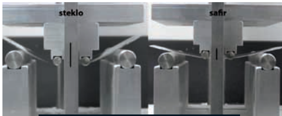
Upogib zaslona iz stekla in safirja tik pred zlomom. Safir prenese nekoliko višjo tlačno obremenitev, a se zlomi že pri manjši deformaciji od stekla. Vir: videoposnetek UBreakiFix.com
