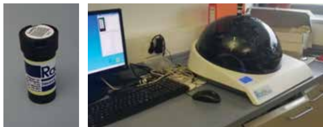
Slika 3: Detektor sledi, ki ga uporabljamo na ZVD (levo), in sistem za štetje sledi (desno).
