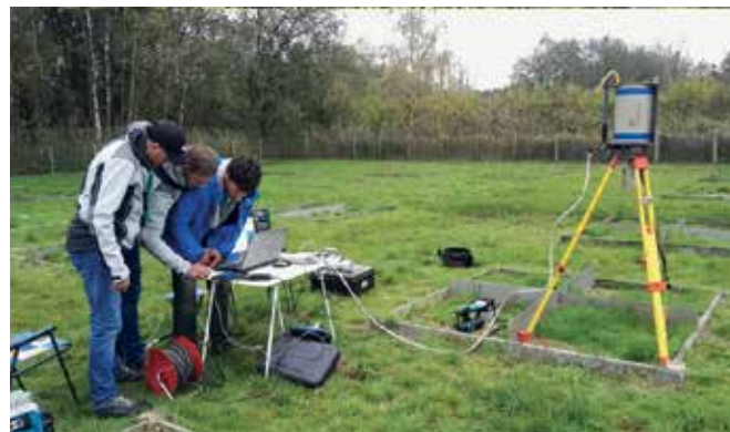
Slika 6: Meritve na kmetiji, na kateri so preučevali prenos radioaktivnih snovi v govedo. Ograjeni pravokotniki so lokacije s povečano radioaktivnostjo. Zelo verjetno je, da so v preteklosti na teh lokacijah zakopali kadavre ali odložili kontaminirano krmo.
