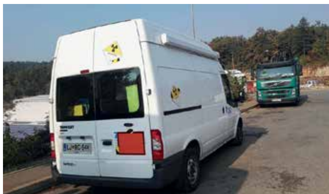
Slika 1: Mobilni laboratorij ZVD za posredovanje v primeru jedrske nesreče. Zgoraj meritve kontaminacije zemljišča, spodaj prevoz radioaktivnega vira,
