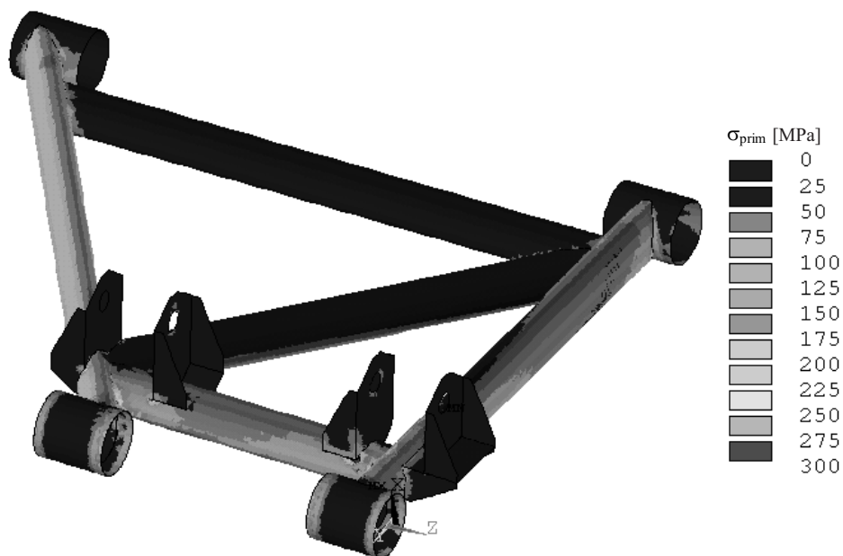
Sl. 11. Primerjalne napetosti na obesi 4 za obremenitveni primer i=43
