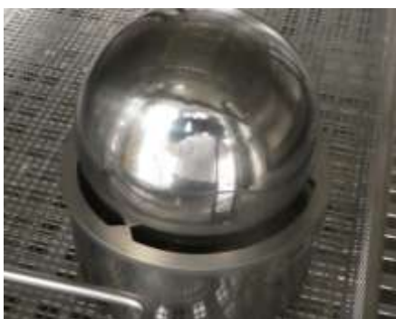
Slika 2: Kondenzacijska krogla(Aesculap AG)
