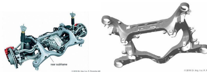
Slika 6. Sestavljena zadnja os iz aluminijastih komponent Porsche Panamera (slika levo) in povečan aluminijast okvir izdelan z nizko tlačnim litjem (slika desno) [8]
