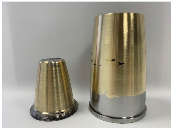
Slika 9. Hibridni multi-materialni orodni vložki izdelani s tehnologijama SLM/WAAM po končani fini obdelavi
