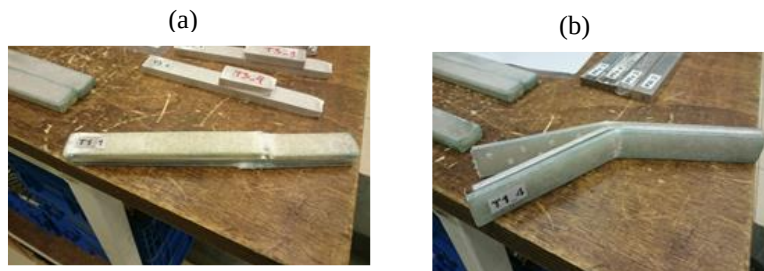
Slika 4. Delaminacija preizkušancev: (a) pri nateznem testu, (b) pri upogibnem testu
