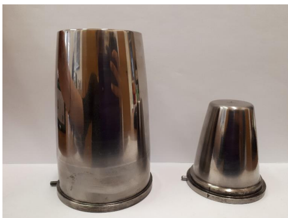
Slika 8. Orodni vložki izdelani s tehnologijo SLM po končani obdelavi
