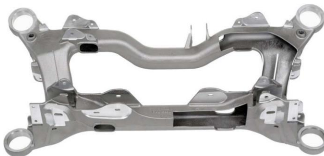
Slika 7. Prototipni okvir podvozja zadnje osi iz aluminijeve zlitine AlSi7Mg izdelan z litjem v pesek [9]
