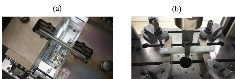
Slika 3. Izvajanje testov na preizkušancih: (a) natezni test, (b) upogibni test
