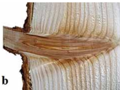
Slika 1: Vzдолžni prerez grče navadnega macesna ( Larix decidua ). Povzeto po a) Leban, b) Zule.
