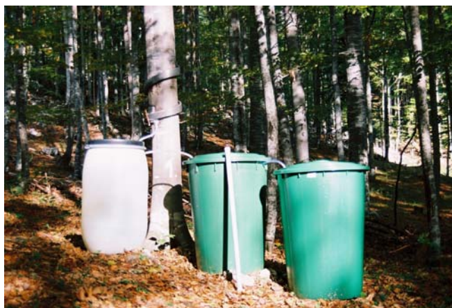
Slika 9: Spiralni vzorčevalni trak za vzorčenje odtoka vode po deblu na bukvi ( Fagus sylvatica L.) Figure 9: Spiral stemflow collector at a beech tree ( Fagus sylvatica L.)
