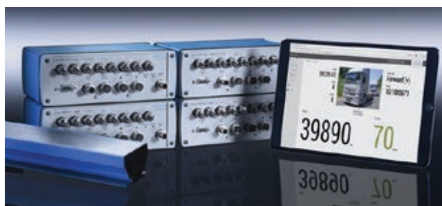
» Kistlerova nova WIM rešitev KiTraffic Plus lahko meri mase vozil pri različnih hitrostih in na skoraj neskončnem številu voznih pasov.
