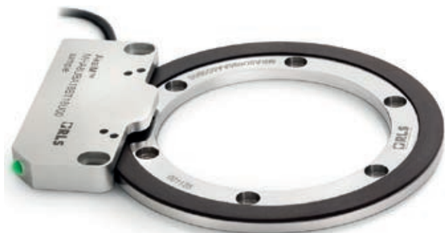
» Magnetni rotacijski absolutni enkoder AksIM.
