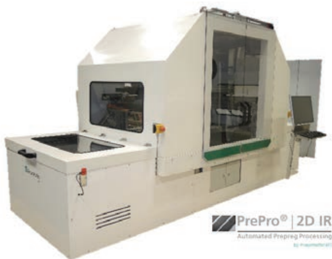
» Slika 1: Sistem »PrePro 2D« za postavitev traku prilagojenih praznih laminatov z in-situ konsolidacijo.
