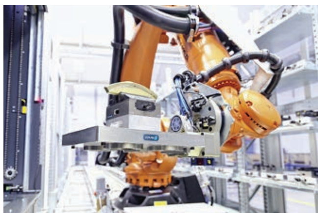
» Palete z vpetimi obdelovanci so shranjene v skladišču obdelovancev in se avtomatizirano naložijo v stroj.
