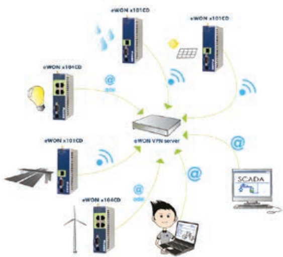
» Slika 2: Prikaz arhitekture VPN-strežnika z uporabo eFive modema. Povezave usmerjevalnikov in uporabnikov konvergirajo v centralno točko, ki jo upravlja VPN strežnik naprave eFive.
