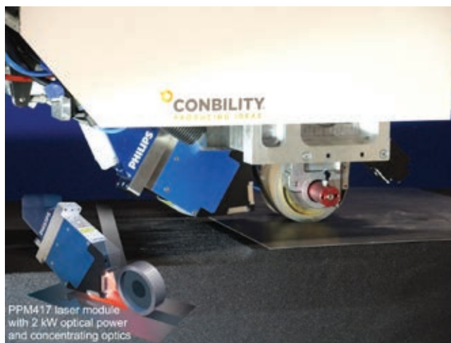
» Slika 2: Aplikator »PrePro 3D« za modularno integracijo v obstoječe proizvodne sisteme.
