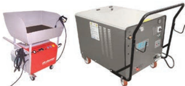
» Sliki 1 in 2: Ročni napravi – pranje z vročo vodo (Cleantec) oz. suho paro in detergentom (REA).
