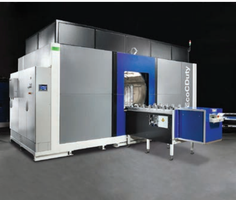
» Modularna naprava za čiščenje s toplimi EcoC-duty, ki deluje povsem pod vakuumom in ima veliko komoro, lahko obratuje z ogljikovodiki ali modificiranimi alkoholi. Delovna komora je primerna za šarže dimenzij do 1.250 x 840 x 970 mm in teža do ene tone.
