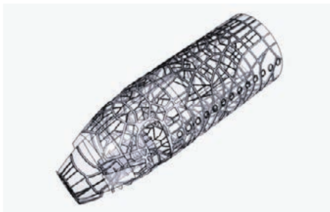
» Diagram, ki prikazuje arhitekturo trupa, izdelanega z uporabo WAAM, z ojačitvami, izdelanimi neposredno na površini (Courtesy STELIA Aerospace)
