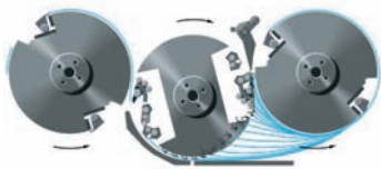
Slika 6. Obratni bobni imata dvojni premer tiskovnih valjev.
