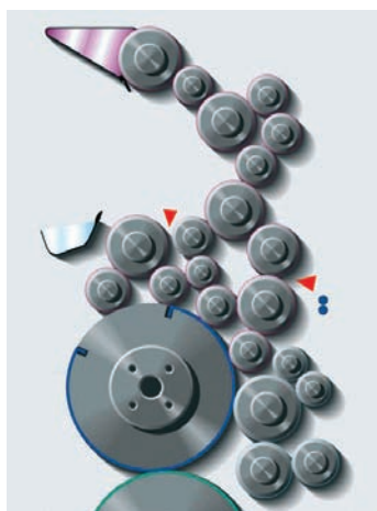
Slika 3. Barvni sistem s šestnajstimi valji in delta efektom.
