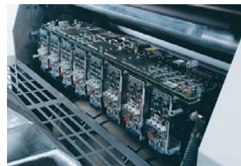
Upodobitvena glava na strojih ADAST DI, zunaj stroja in v tiskovnem členu ob ploščnem valju.
