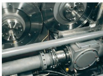
Slika 4. Dvojni pogon z zobčniki in longitudinalno osjo.
