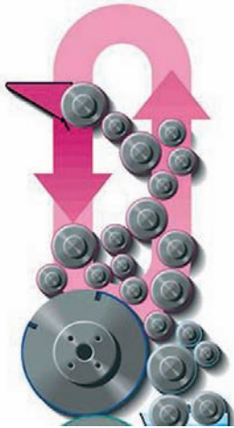
Slika 6. Obratni bobni imata dvojni premer tiskovnih valjev.
