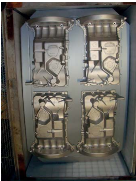
Slika 1: Postavitev aluminijastih ulitkov v mrežastih zabojih
