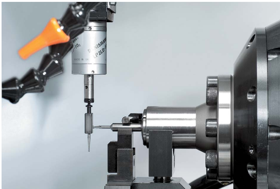
Sistem za samodejno pozicioniranje in meritve Heli-Probe zbira pomembne parametre orodja in skrbi za kar najhitrejšo pozicioniranje orodja.
