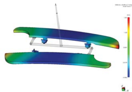
Slika 8: Deformacija pokrova – osnova za izdelavo nasprotno deformacije
