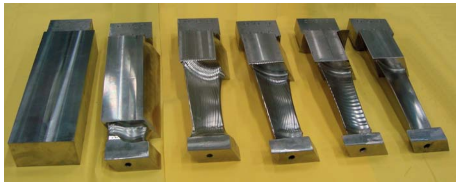
Slika 10: Primeri lopatic in različne stopnje obdelave
