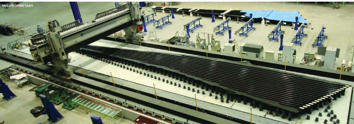
Stroj za obrezovanje kril z abrazivnim vodnim curkom MHI dim. 36 x 9 m
