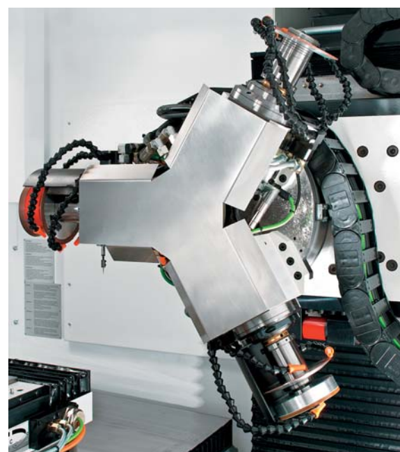
Helitronic Micro je s tremi vreteni za 12 brusnih kolutov zasnovan za fleksibilnost, ki je pri mikroorodjih in orodjih s kompleksnimi geometrijami nepogrešljiva.
