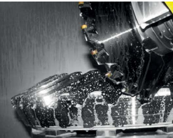
Slika 5: Freziranje zobnika s frezalom z inserti
