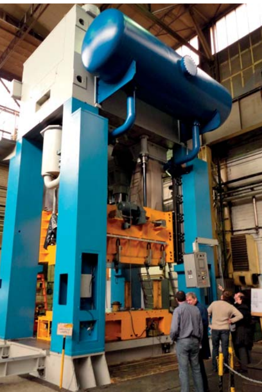
14.000 kN stiskalnica dobavljena v PSA Vigo
