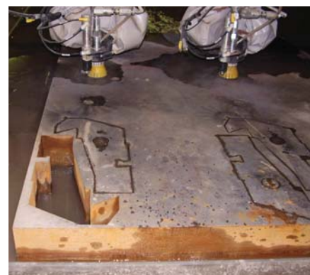
Rezanje debelejših kovinskih plošč z dvema dinamičnima rezalnima glava
