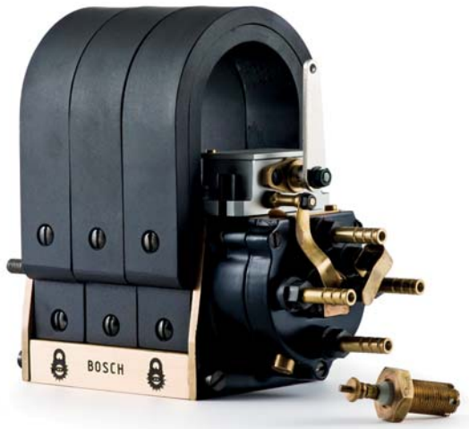
1902: Prvi Boschev visokonapetostni sistem magnetnega sistema vžiga s svečko.
