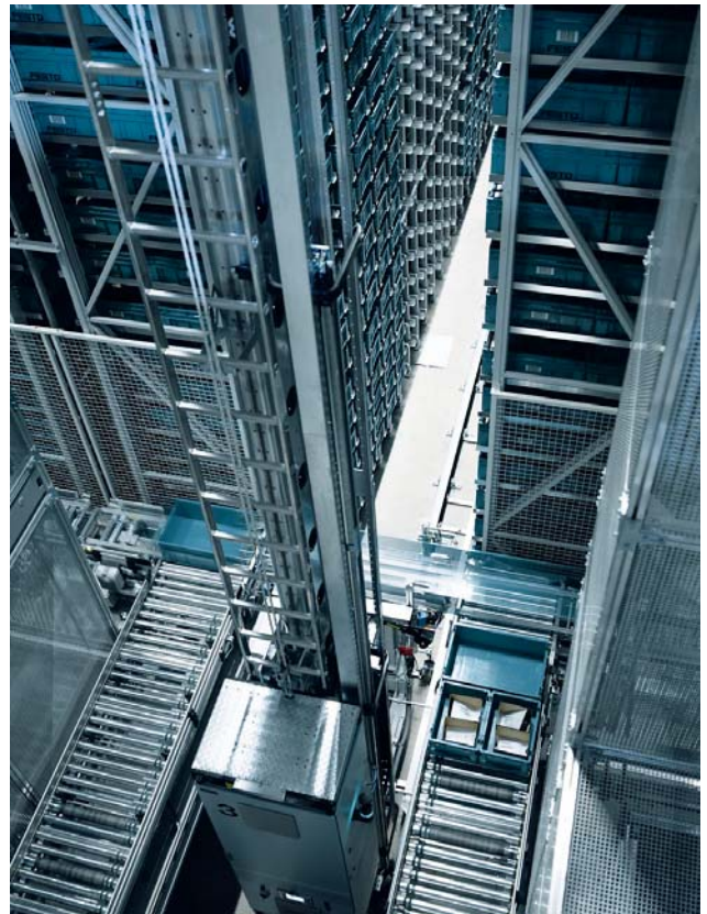
Gotovi izdelki se skladiščijo in pripravijo za odpremo v tako imenovanih področnih storitvenih centrih, kjer delo poteka avtomatizirano in vodeno s črtno kodo, kar zagotavlja učinkovito odpremo ter točno in pravočasno dobavo. (Foto: Festo)
