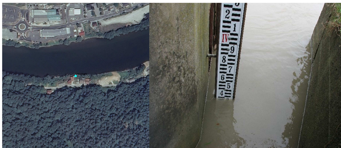
Slika 1: Vodomerna postaja na Litija I na reki Savi – lokacija in vodomerna letev (ARSO, 2014b)
