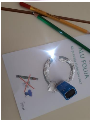
Slika 216: LED-dioda zasveti. (lasten vir, 2019)
