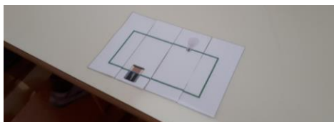
Slika 217: Sestavljena shema električnega kroga. (lasten vir, 2019)
