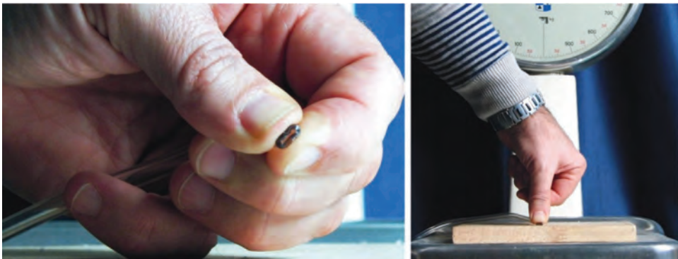
Slika 5: Merjenje sile mišic s stiskanjem cevke. Najprej stisnemo cevko med prsti tako, kot da bi izstreljevali koščico (levo). Nato položimo cevko na tehtnico in pritisnemo s prstom tako, da dosežemo enako deformacijo cevke kot prej (desno).
