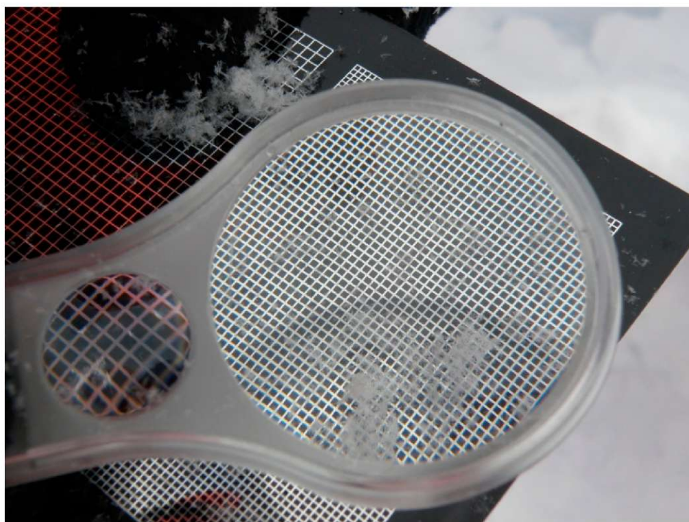
Določevanje vrste kristalov v snežni odeji - lupa in ploščica z rastrom
