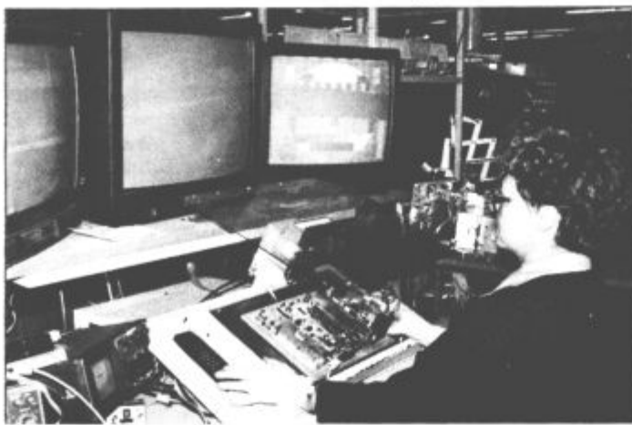
Televizor je plod lastnega znanja in tehnoloških rešitev. Ključna mesta v proizvodnem procesu so naprave za umerjanje in funkcionalno testiranje šasije televizorja.
