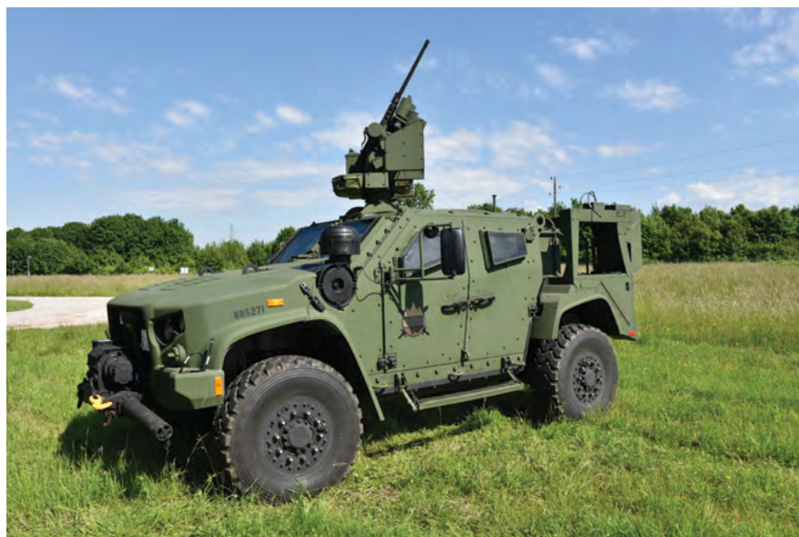
LKOV 4×4 z vgrajeno oborožitveno postajo in oborožitvena postaja Protector M153
