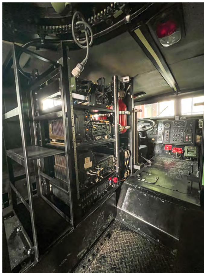
Vgrajen sistem C4I s pogledom na preoblikovan in nadgrajen kokpit voznika v ozadju
