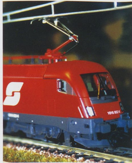
Dovod elektrike v lokomotivo prek zgornjega odzemnika
