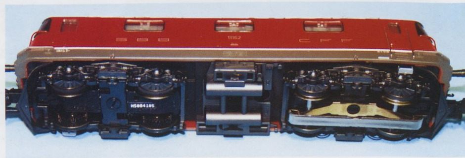
Spodnji dovod faze v lokomotivo prek drsnika
