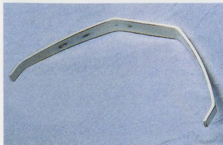
Pramodel podvozja, ki bo v seriji narejen iz ogljikove tkanine. Orodje za podvozje je sestavljeno iz treh delov.
