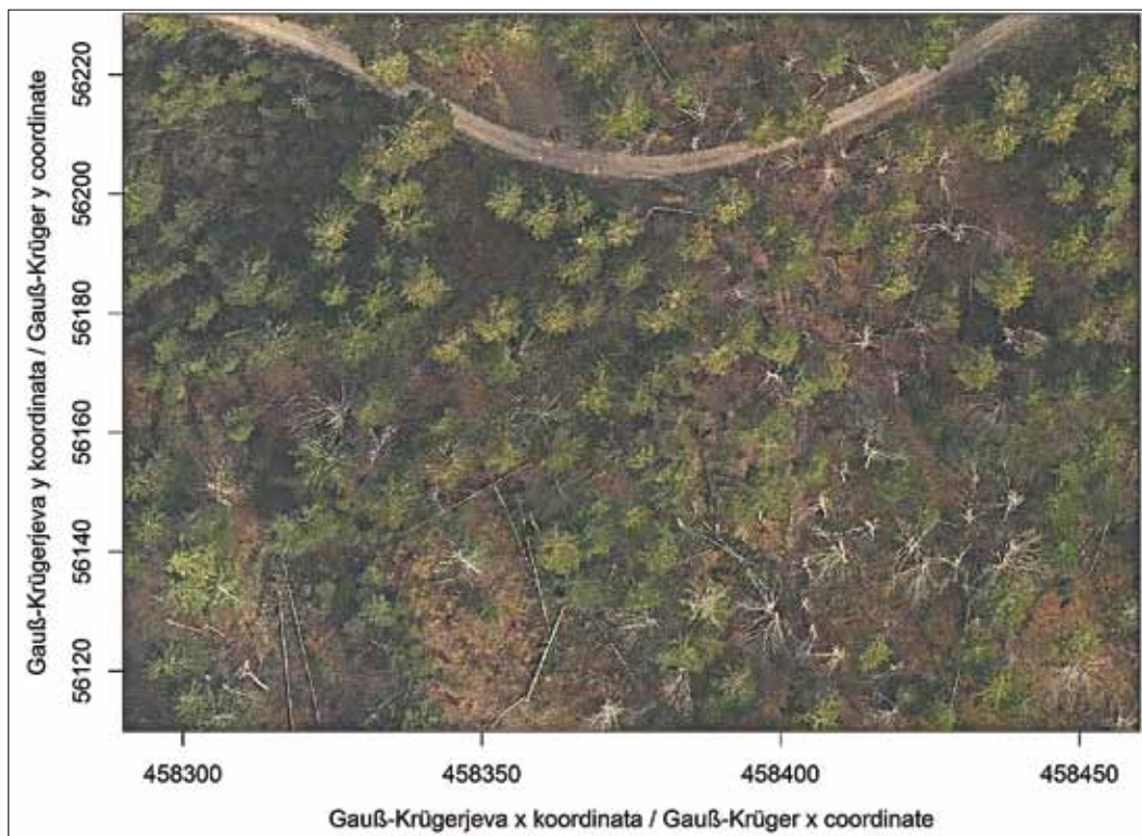
Slika 9: Primer ortofoto posnetka visoke resolucije (velikost slikovne celice je 7 \times 7 cm) z območja GGE Leskova dolina, ki je bilo posneto aprila 2014. Razpoznati je mogoče ceste, vlake ter poškodbe krošenj dreves in izrita drevesa. Kartografija: Milan Kobal.
