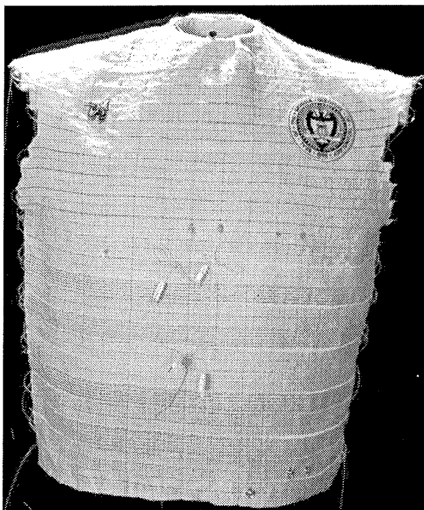
Slika 6: »Računalniška osnovna plošča, ki jo lahko oblečemo«, »Smart Shirt« /1, 30/
