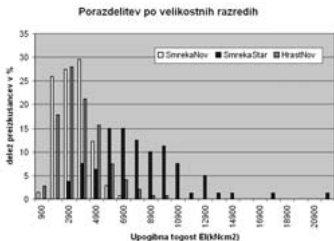
Slika 11: Velika odstopanja upogibne togosti preizkušancev. Large deviations in bending resilience of samples.
