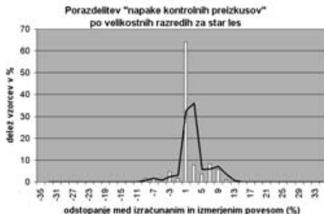
Slika 6: Porazdelitev odstopanja za star smrekov les na t.i. "paralelnem" statičnem modelu. Distribution of deviations for old spruce wood in the so called parallel technical mechanics model.
