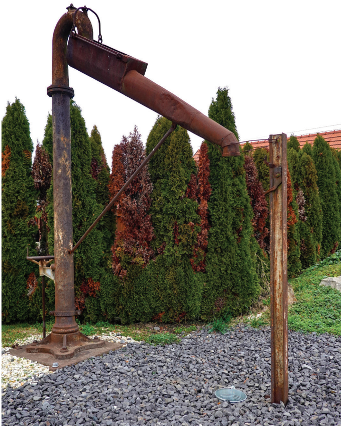
Napajalnik za vodo za opremo parnih lokomotiv iz leta 1846. 2
