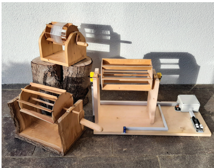
Kopija odvijala iz Masanzzaga (v ozadju), odvijalo iz murvovega lesa (levo) in odvijalo za polavtomatsko odvijanje svilenih kokonov (desno). Foto: Katarina Vaupotič.
