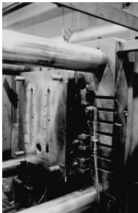
Slika 1: Zadnji kalup orodja za tlačno litje Figure 1: Fixed half of die-casting die
