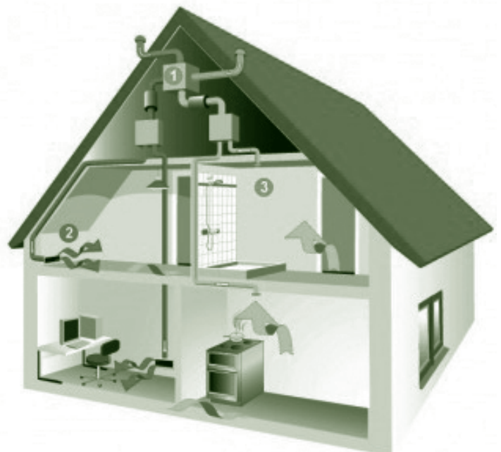
Slika 3: Prikaz delovanja prisilnega prezračevanja z rekuperacijo
