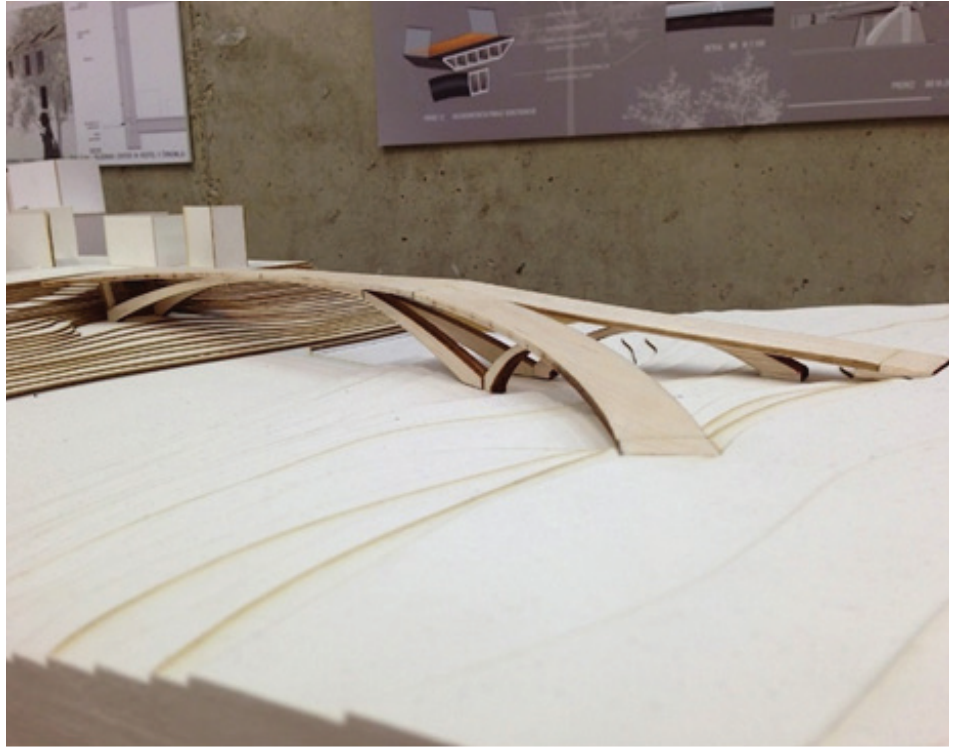
Koncept 5 – ločni most z dodatnima lokoma na bregu in razcepljeno tlorisno konfiguracijo (oporni temelji, razcepljena os in ukrivljena os prenosa sil na bregova)
