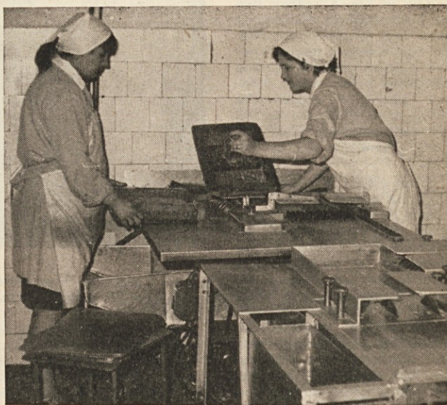
Polavtomatično strojno rezanje napolitank
