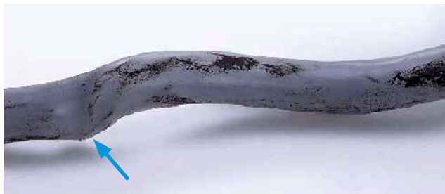
► Slika 7: Zaradi slabega vodenja vodnikov v notranjosti kabla jih je nekaj preskočilo, tako da so naredili zanko. Na tem mestu vodnik običajno predre plašč
