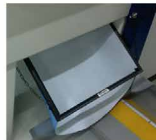
Trajne drče ali lijaki pod orodjem za izdelke brez poškodb.
