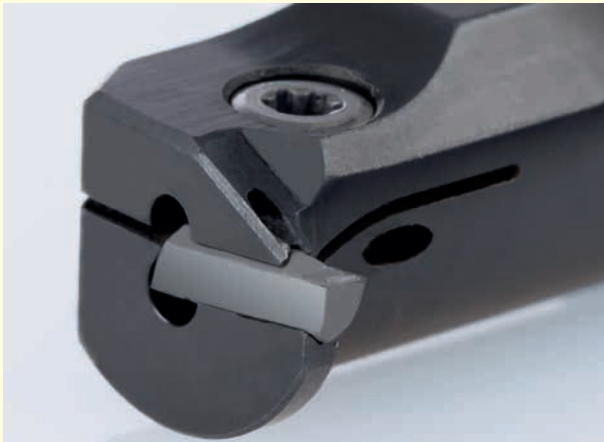
► Dovod hladilne tekočine prek vpenjalnega prsta in dodatna šoba v steblo/vratu za najdaljšo dobo uporabnosti in učinkovito odstranjevanje odrezkov
