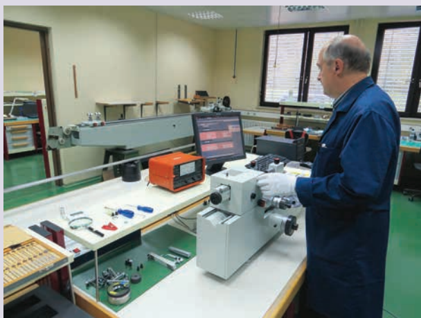
» Kalibracija etolana na enosnem dolžinskem merilnem stroju.
