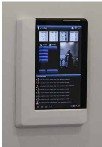
› Slika 3: Tablični računalnik z operacijskim sistemom Android je prosto nastavljen pri vratih. Uporabnik naloži aplikacijo e-vratar na tablico ali pametni telefon. Uporabniški vmesnik omogoča pregled informacij o stanju in dogodkih, povezanih z vrati. Tablico lahko po potrebi hitro snamemo z vrat.
