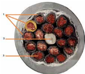
› Slika 4: Primer kablov, ki nima optimalnih rešitev jedra, vodnikov in plašča, kolobarjasta razporeditev vodnikov
