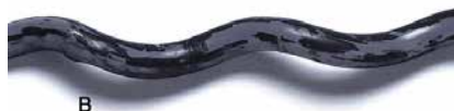
B – »Visokofleksibilni« kabel. Zaradi nepravilne strukture vodnikov (opletenost) v kablu pride do torzijske zvitosti (»spiralnosti«) kablov, čemur sledi pretrganje žic.
