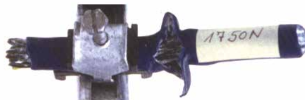
► Slika 10: Poškodba plašča na mestu pritrditve kabla – premajhna tlačna trdnost plašča in neprimerna pritrditev
