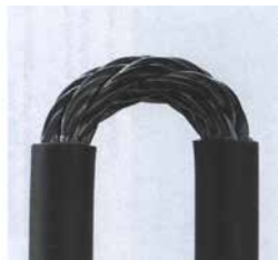
› Slika 2: Tlak in nateg na mestu upogiba povzročita premikanje vodnika v notranjosti kablov.
