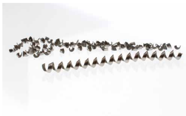
› Enojni dolgi odrezek, ki je nastal med klasičnim dovajanjem hladilnega sredstva pod tlakom (spredaj), in razbiti krajši odrezki za lažje odvajanje odrezkov (zadaj), ki nastanejo po uporabi visokotlačne usmerjene šobe Seco Jetstream Tooling®
