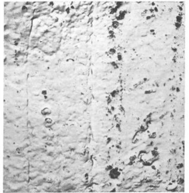
Slika 8 in 9 × 6000. Dvostopenjska replika: plastična snov — oglje. Mikrofraktografske značilnosti prelomne površine.
