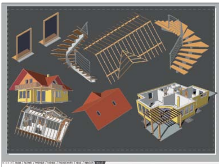
Novo orodje za vnos 3D-pogledov v Layout nam omogoča izdelavo "kolažev" različnih pogledov na celoto, etaže ali samo posamezne arhitekturne elemente.
